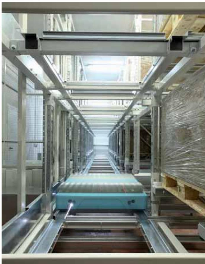
Prototipo di Asrv in fase di testing.
